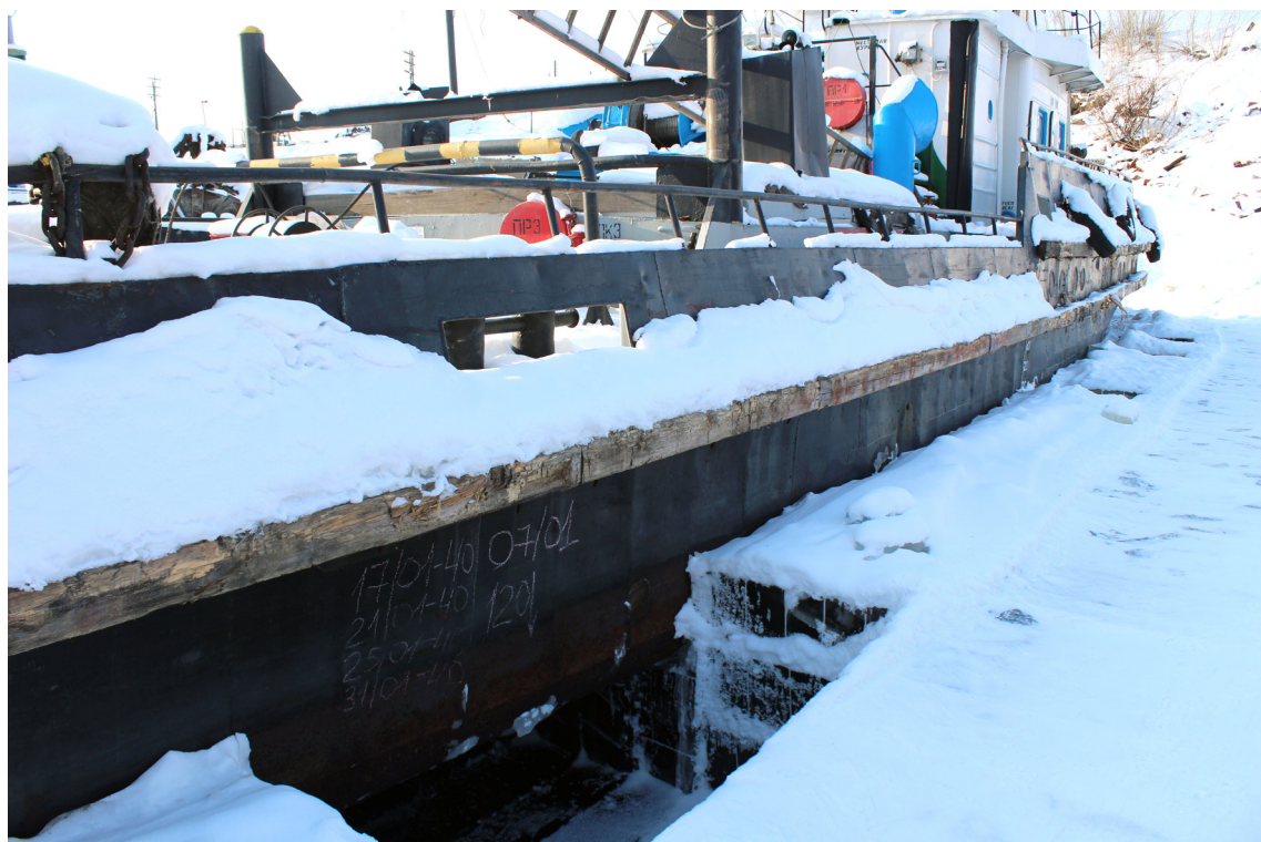
Фото 5. Выморозка судов в Жатайском затоне, март 2022 г. Фото автора [Fig. 5. Vymorozka of vessels in Zhatay dockyard. March 2022. Photo by author]
